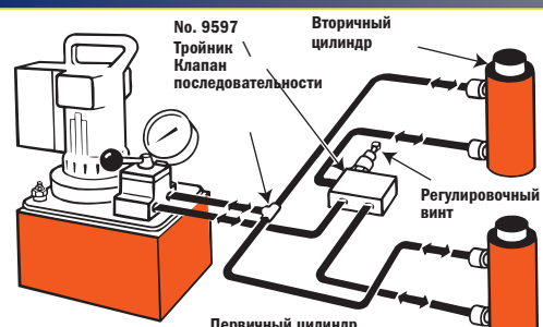
6 Цилиндр двустороннего действия с клапаном последовательности, регулирующим контуры первичного и вторичного цилиндров
