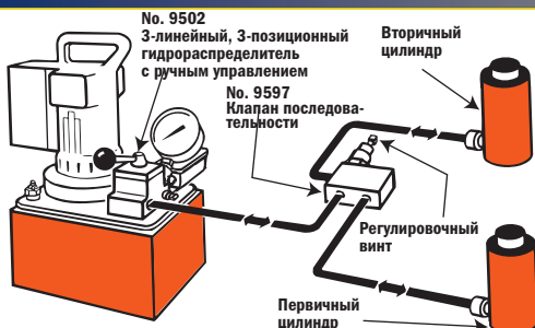
5 Цилиндры одностороннего действия с клапаном последовательности, регулирующим контуры первичного и вторичного цилиндров
