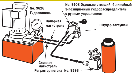
3 Цилиндр одностороннего действия в контуре, управляемом дистанционным клапаном
