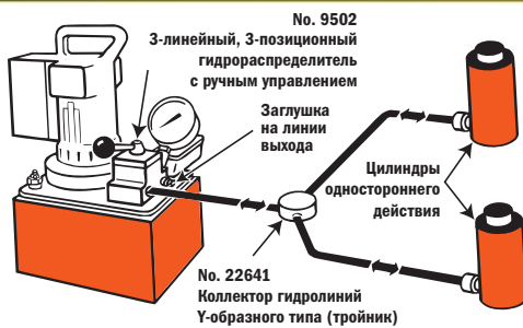
1 Цилиндр или цилиндры одностороннего действия в контуре, управляемом установленным на насосе клапаном
