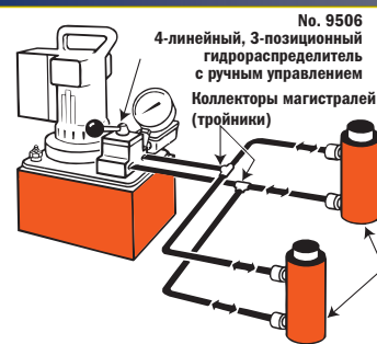
2 Цилиндр или цилиндры двустороннего действия в контуре, управляемом установленным на насосе клапаном
